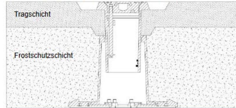
4. Kappe auf Höhe Tragschicht gesetzt und freigemacht
