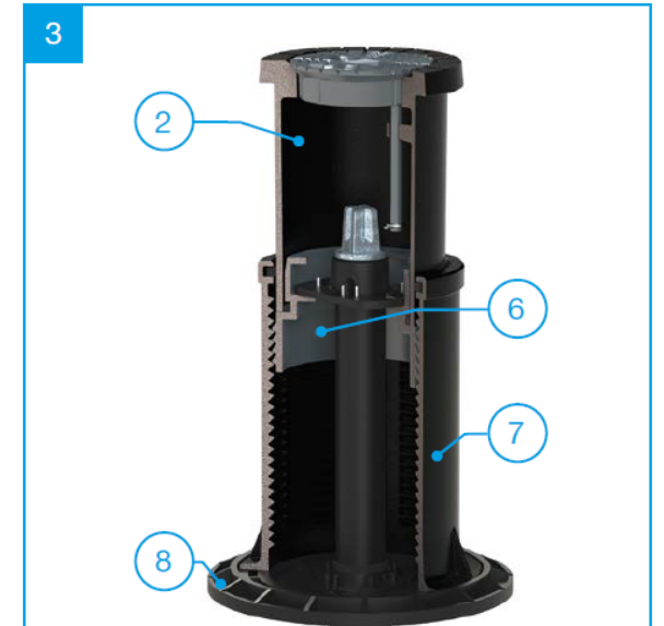
Abbildung: Gewinding (6) ist oben, die formschlüssige Verbindung mit Gewinding (6) und Ziehring (2) ist hergestellt und ermöglicht somit den Lastabtrag über die Grundkappe (7) bzw. Tragplatte (8).
