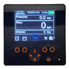
Einstellbar wahlweise auf Gallonen pro Minute (us gp/m), Liter pro Sekunde (l/s), Liter pro Minute (l/m) und Qubikmeter pro Stunde (m³/h) zur Anwendung bei:
