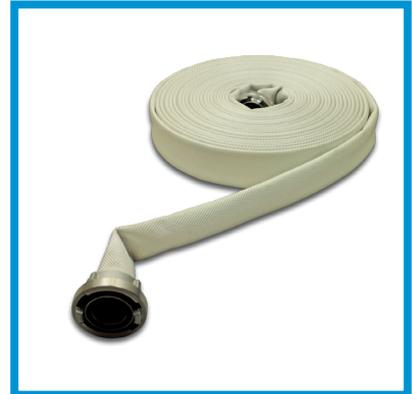
Synthetischer Polyesterschlauch mit hochwertiger Innengummierung aus EPDM mit farbiger Außenbeschichtung aus Polyurethan.
