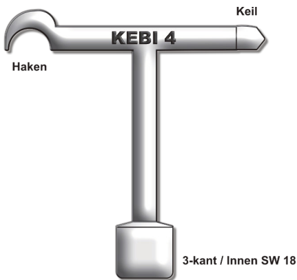
Bedienungs- und Öffnungsschlüssel KEBI 04 Öffnungshaken Öffnungскеil 3-kant / Innen 18 mm
