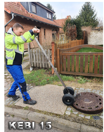
KEBI 15 (Schuller KOMBI 260) Schachtdeckelheber für schnelles, sicheres und rückenschonendes Heben aller Schachtdeckel PATENTIERTER ARBEITSSCHUTZ!
