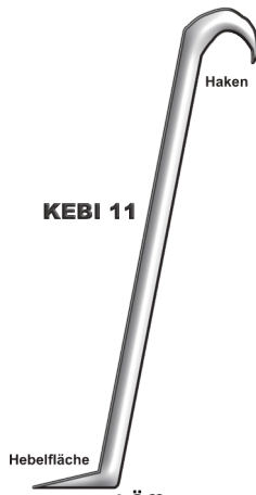
Bedienungs- und Öffnungsschlüssel KEBI 11 Hebelfläche für geklemmte Schachtabdeckungen Aushebe - Haken
