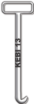
Bedienungs- und Öffnungsschlüssel KEBI 13 Standard - Kanalhaken 16 mm Rundstahl geschmiedet und verzinkt Gesamtlänge ca. 900 mm
