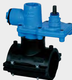
239-01 Aufschweiß-Hawlinger mit horizontaler ZAK ® -Muffe in Rohrrichtung
