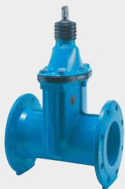
471-00 Keil-Oval-Schieber „E2“, PN 25, Baulänge Grundreihe 15 nach DIN EN 558-1
